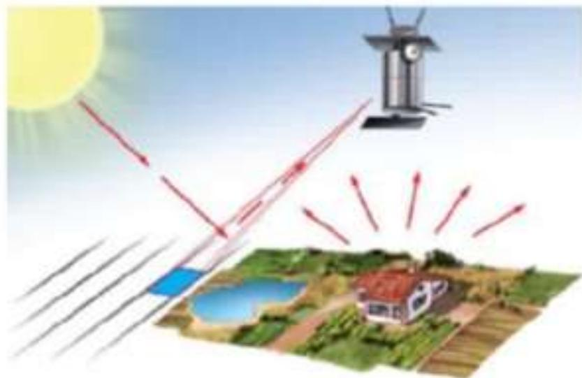
Captan las radiaciones emitidas por los objetos a partir de la energía solar.
