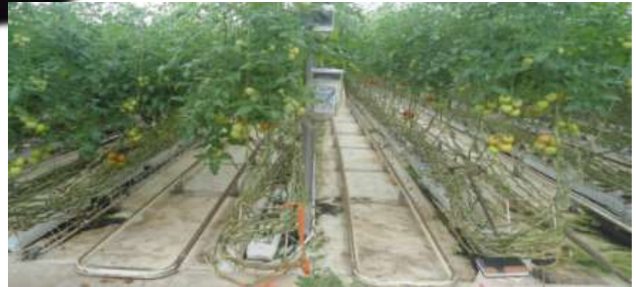
Sensor hiperspectral 400-1000 Modelo PFD-CL-65-V10E con resolución espectral de 3.5 nm
