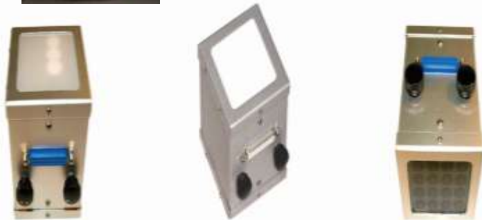
Figura 4. adiómetro multispectral modelo CROPSCAN®-MRS8s, utilizado para la obtención de firmas espectrales en Tepalcatepec, Michoacán.
