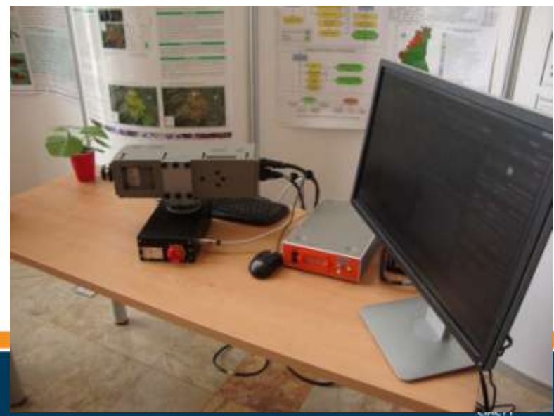
Sensor hiperspectral 400-1000 Modelo PFD-CL-65-V10E con resolución espectral de 3.5 nm
